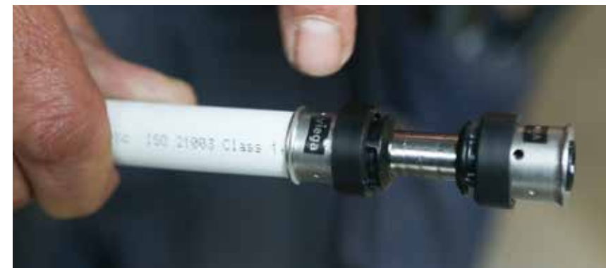
L'absence de joint torique facilite le montage : il suffit d'insérer le raccord à la bonne profondeur et ensuite de le sertir.
