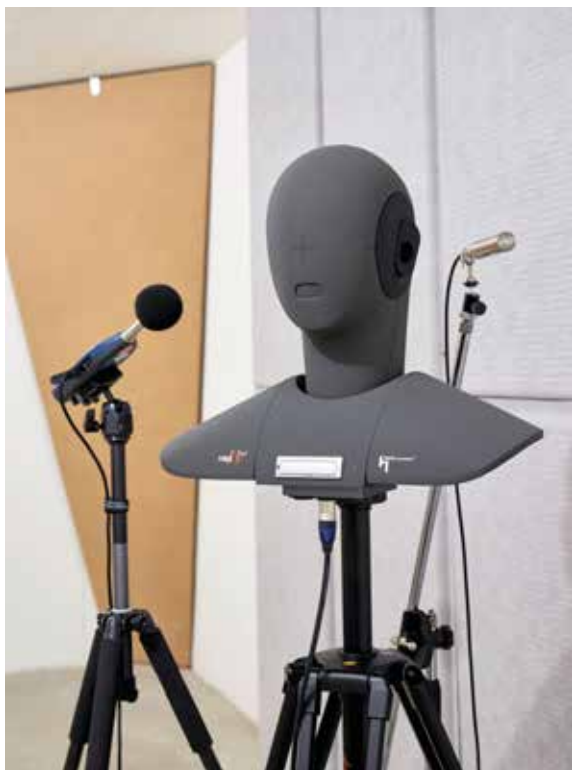
Les experts en acoustique de Geberit utilisent également un système de mesure comprenant une tête artificielle à la pointe de la modernité pour enregistrer et analyser les bruits des sanitaires. Ce système permet un enregistrement auditif précis des sons qui surviennent.
