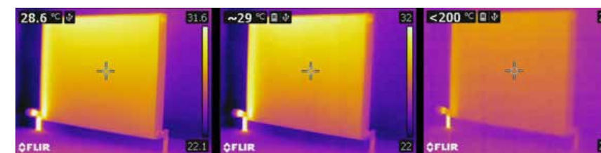
Figuur 4 Beelden van een FLIR T440 met een temperatuurbereik van -20 tot +120 °C, (links), 0 tot +650 °C (midden) en +250 tot +1200 °C (rechts). Alle andere instellingen zijn identiek.
