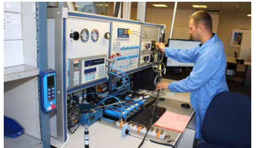
Le laboratoire possède un banc de test permettant de calibrer différents appareils en même temps.
