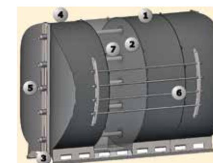
Figure 2: Ce ballon tampon UniSto-vat se compose de quatre modules. Les éléments sont: 1) Habillage. 2) Fine plaque d'acier. 3) Rails. 4) Module terminal résistant à la pression. 5) Conduites de charge et de décharge. 6) Barres de liaison. 7) Étanchéité.
